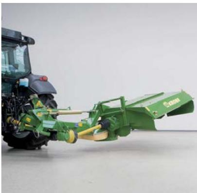
Rápido y sencillo: tras la llegada a la cabecera, los cilindros de efecto sencillo elevan la máquina para sacarla de la posición de trabajo. Los brazos de conexión del tractor no se mueven.
