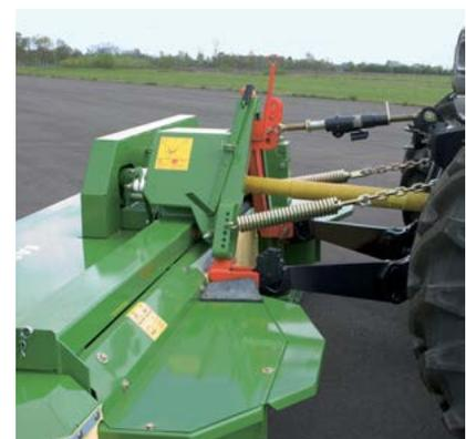
Un sistema perfecto: el control de la presión de apoyo es sencillo. Tan solo hay que modificar la tensión del resorte helicoidal en un sistema de fijación de pasadores y la longitud de la cadena. La conexión superior telescópica mejora la adaptación al terreno en la dirección del desplazamiento.
