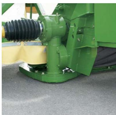
Accionamiento directo: el sistema de acondicionador de rodillos incluye un sistema de accionamiento mediante engranajes directos y sin resbalamiento. El engranaje que acciona el rodillo inferior está integrado en el grupo de la barra de corte situada detrás del tambor superior interior.
