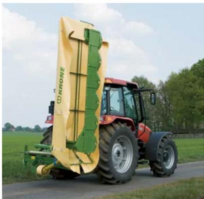
Útil: solo es necesario un empalme hidráulico de efecto simple para mover las segadoras EasyCut 280 y 320 de enganche posterior de KRONE de la posición de trabajo a la cabeceras o a la posición de transporte y viceversa.
