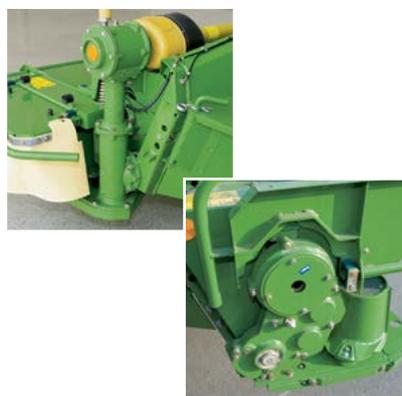
Accionamiento positivo: los rodillos de acondicionamiento accionados por engranajes incluyen un revestimiento de poliuretano resistente. El engranaje del rodillo inferior forma parte del sistema de accionamiento de la barra de corte mientras que el rodillo superior está accionado por un grupo del rodillo inferior.
