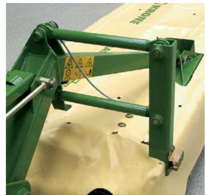
La presión de apoyo se puede ajustar cómodamente a las necesidades. Los muelles helicoidales de fácil regulación proporcionan una adaptación rápida y perfecta a todas las circunstancias. La cinemática entre los muelles helicoidales y el larguero de carga mantiene una presión de apoyo casi constante, incluso en terrenos con ondulaciones.
