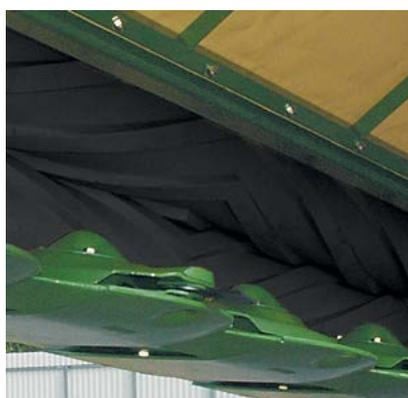
Agarre firme a la materia vegetal: los rodillos del acondicionador de diámetro grande y perfil cuneiforme se engranan para aplastar, rallar y doblar la materia vegetal con gran intensidad.
