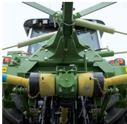
El accionamiento: el grupo principal montado centralmente en la estructura principal transmite la fuerza del tractor directamente a los accionamientos, que incluyen embragues de fricción integral y marchas libres para proteger tanto al tractor como la segadora de sobrecargas. La velocidad de la toma de fuerza necesaria es 1.000 rpm.
