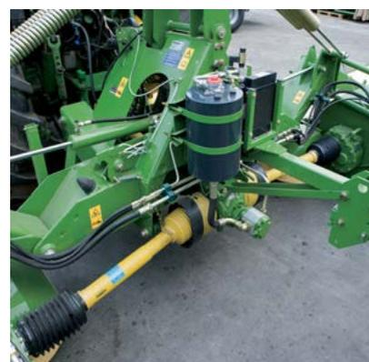
Sistema hidráulico independiente: el suministro de aceite del agrupador de hileras procede de un depósito de aceite separado, lo cual lo dota de independencia respecto al sistema hidráulico del tractor. Un radiador del aceite protege al sistema de sobrecalentamientos.
