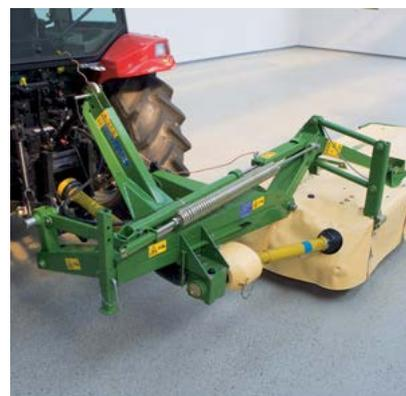
Perfecto: cuando el sistema de protección contra impactos choca contra algo, la segadora oscila hacia atrás y levanta el borde de corte para extraerlo de la posición de trabajo y deslizarlo por encima del obstáculo. Un sistema que proporciona una protección máxima, en concreto en terrenos pedregosos.
