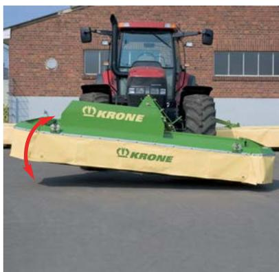
Un sistema ideal, EasyCut 28 P y 32 P incluyen caballetes oscilantes que permiten un recorrido lateral de 40 cm aproximadamente para un desplazamiento fácil sobre cualquier terreno. Los modelos también disponen de frenos regulables que alinean la máquina horizontalmente durante el transporte por carretera y los giros en los promontorios.
