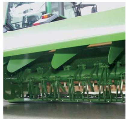
Acondicionamiento de ancho completo: con los mayales de acero en V y la chapa acanalada, el acondicionador abarca todo el ancho de trabajo, desde el tambor de izquierda a derecha. El objetivo es un flujo uniforme de la materia vegetal por toda la superficie de trabajo y unos resultados óptimos del acondicionamiento. Las placas de dirección opcionales están disponibles para obtener un esparcido a lo ancho y un acondicionamiento incluso más rápido.
