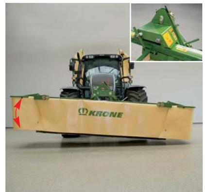
Las condiciones especiales requieren soluciones especiales. En los modelos EasyCut 28 M y 320 M se pueden instalar placas de deflectores especiales, que ayudan a formar hileras uniformes en terrenos en cuesta, incluso cuando se siega en una pendiente.
