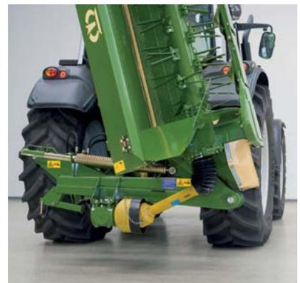
Altura baja de transporte: Gracias a su baja posición de oscilación en el caballete, el brazo en V puede plegar incluso un modelo de EasyCut de 3,14 mm hacia un lado en una posición de transporte vertical.
