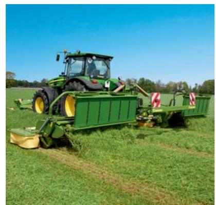
No se queda nada atrás: los acondicionadores de segadoras CV que disponen de agrupador de hileras cuentan con mayales de acero en V sólidos y un depósito de acero debajo del rotor que recoge hasta la más mínima broza.
