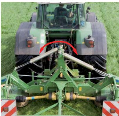
Sistema de suspensión de equilibrio patentado: este sistema patentado distribuye la presión de apoyo de manera uniforme entre ambas segadoras para garantizar cortes más limpios incluso en los terrenos más difíciles.
