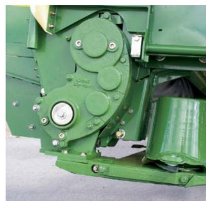
Dos rodillos, dos accionamientos: el rodillo superior está accionado con un grupo independiente situado en el extremo derecho de la barra de corte y está sincronizado por el rodillo inferior.
