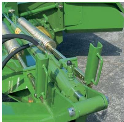
Cambios entre posición de transporte y de trabajo: Un cilindro de acción doble pliega la máquina hasta la posición de transporte de 110° y la baja de forma activa de nuevo a la posición de trabajo.
