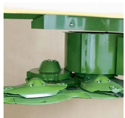
Hileras más anchas: los tambores superiores situados en el interior de EasyCut 32 y 32 P se pueden sustituir con versiones de colocación más baja que generan hileras de 40 cm de ancho, una solución ideal para las segadoras posteriores de esparcido a lo ancho.
