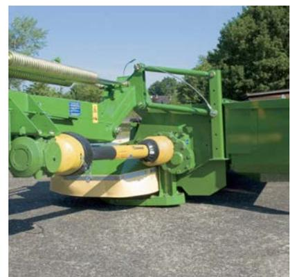
Resistentes y totalmente herméticas: las barras de corte están soldadas por completo por robots avanzados y con sistemas CNC para atender las necesidades y los niveles de calidad más específicos. Después de todo, la barra de corte es el núcleo de una segadora de discos.
