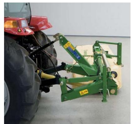
Diseño resistente y sencillo: el caballete robusto soporta la máxima tensión y dispone de un perno de conexión superior regulable en altura y un compartimento de almacenamiento para recoger el árbol de transmisión cuando la máquina está estacionada.
