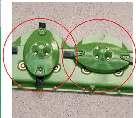
Los pernos de las cuchillas gastados y las piezas sujetas a desgaste no son un problema en EasyCut de KRONE porque se pueden sustituir en pares. Los pernos se pueden sustituir con tornillos roscados previa petición.
