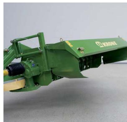
Hileras anchas y estrechas: todas las segadoras con acondicionador EasyCut CV incluyen placas de dirección exteriores, que oscilan hacia dentro y hacia fuera de su posición para regular el ancho de la hilera según las necesidades.
