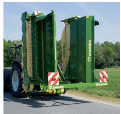
Movilidad compacta: un ancho de transporte estrecho de 3 m y menos de 4 m de altura de transporte favorecen los desplazamientos seguros en las ajetreadas vías públicas. El usuario disfruta de una visibilidad completa mientras que la conexión próxima al tractor permite desplazarse a velocidades rápidas.
