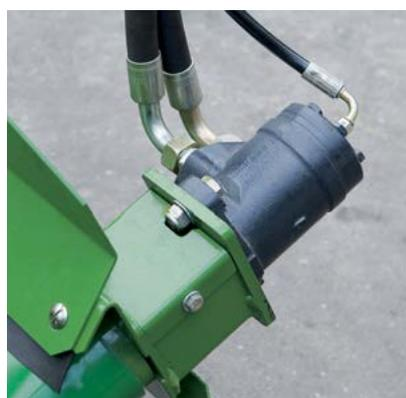
Los potentes motores hidráulicos y las velocidades del transportador de variación infinita permiten regular el ancho de las hileras a los requisitos de la siguiente cosechadora. El motor se desactiva automáticamente cuando las cintas se elevan y se vuelve a activar cuando bajan de nuevo a la posición de trabajo.
