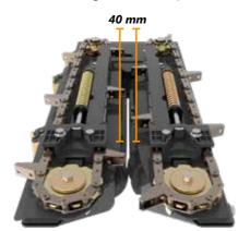
A Brava + possui regulagem elétrica das chapas despigadoras, acionada através de controle remoto, porporcionando uma variação da abertura de 20 mm para 40 mm. As regulagens são feitas de acordo com a espessura da cana do milho, de maneira fácil e rápida.
