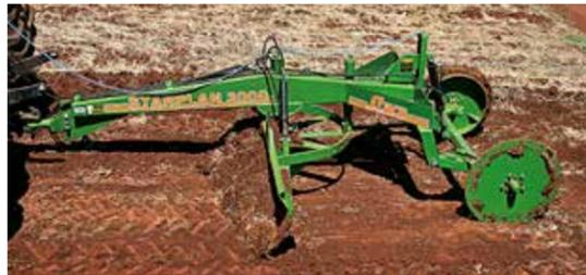
Ruedas guía, importante opcional para la construcción de terrazas y evitar el deslizamiento lateral.
