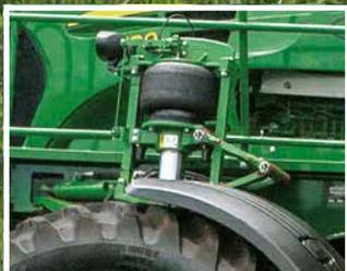
El sistema de nivelación automático de la suspensión ayuda a mantener el chasis siempre nivelado, operando con estabilidad y confort.
