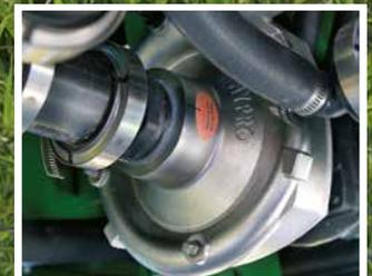
Bomba de acero inoxidable: mayor vida útil y mayor resistencia a la corrosión, pudiendo ser utilizadas con productos tales como fertilizantes líquidos y compuestos de reacción ácida.
