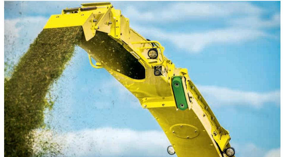
El Control de Llenado Activo (AFC) es un sistema de carga automática e inteligente de alta precisión. Posee una cámara 3D ubicada en el tubo de descarga que permite trabajar eficientemente de día o de noche y con todos los cultivos, incluso con polvo. El AFC también le posibilita a los operadores utilizar múltiples estrategias de carga, como la carga diagonal, invirtiendo la posición al cambiar de lado.
