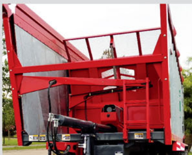
EXCLUSIVO SISTEMA DE COMPACTACIÓN Y DESCARGA SIN BASCULAR. LANZA CON REGULACIÓN DE ALTURA.
